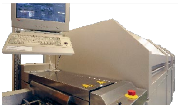
Zuverlässige Verarbeitung im Reflowverfahren
